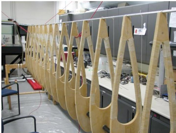
**Figure 7-8 Trailing Edge Stiffening Element**
